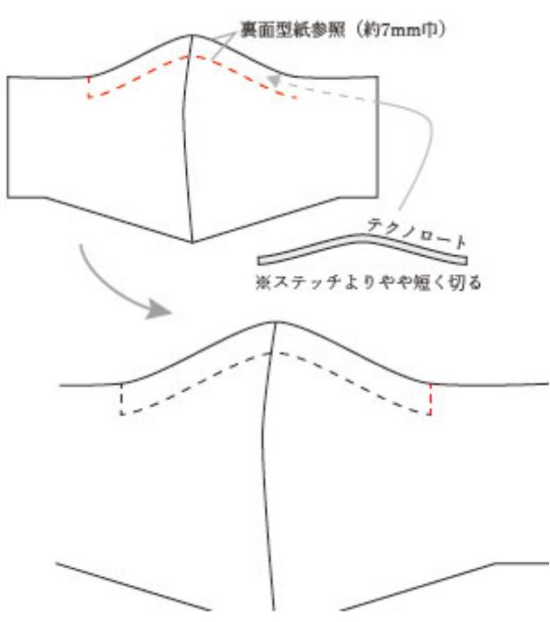
③表に返し、鼻側に一邊あけてステッチをし、テクノロートを入れてステッチで閉じる。
